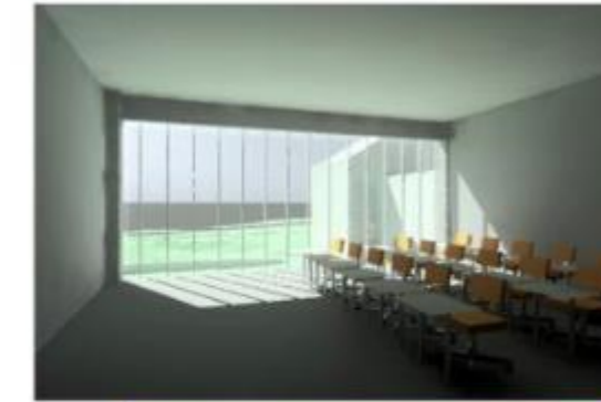
Exemplo de simulação de luz natural com sol incidente na fachada (referência St Albans School—Washington DC). A imagem mostra a penetração de sol incidente nas zonas ocupadas, indicando risco de ofuscamento.
